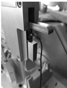
图7 校准切割负载力时测力传感器安装位置
