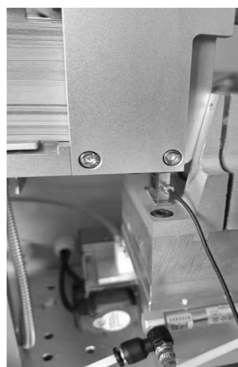
图7 校准切割负载力时测力传感器安装位置
