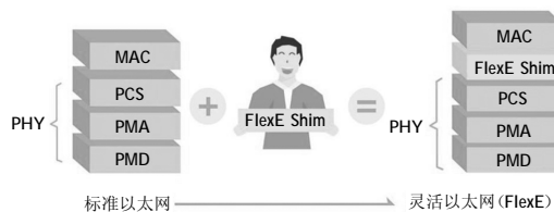
图 1 FlexE 技术原理
